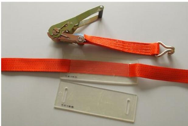
**Informations générales :** Les plaques de protection en PU peuvent être utilisées pour offrir une protection supplémentaire aux sangles de levage contre les arêtes vives et pour veiller à ce que la charge ne soit pas endommagée. La sangle se glisse par les deux ouvertures de la plaque de protection. La plaque peut aller et venir librement et est facile à positionner.
